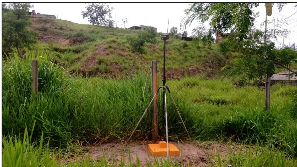
Figura 2 – Exemplo do padrão de vértice geodésico
