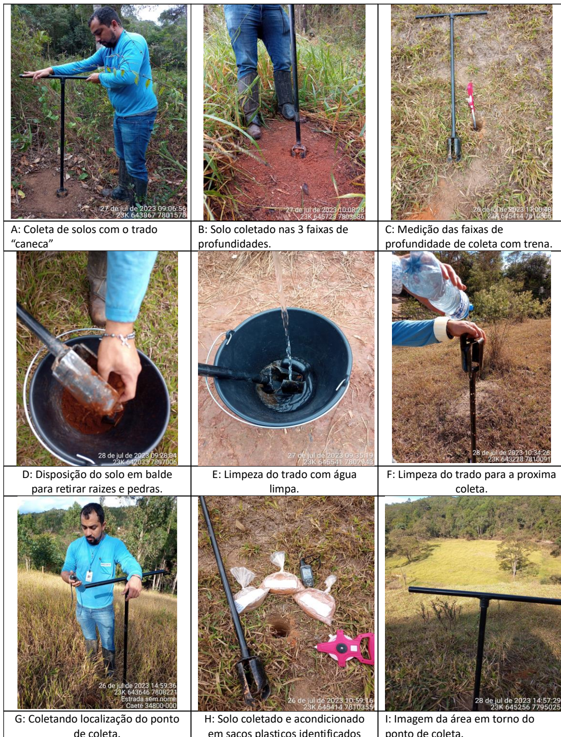
Figura 3-1 – Sequência das atividades realizadas para a coleta das amostras de solo na área de abrangência da bacia do ribeirão Ribeiro Bonito, Caeté, Minas Gerais.
